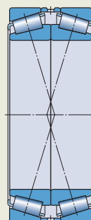
Rodamientos apareados con una disposición cara a cara
